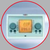
**Unidad de mando BM** para trabajar en descenso progresivo de  $t^{\circ}$  de caldera con compensación de temperatura exterior mediante sonda exterior y/o con compensación de temperatura ambiente.
